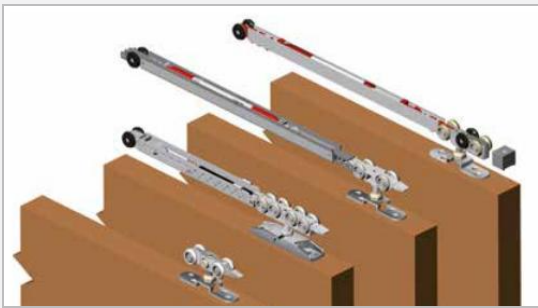
Versión Complete: carro y amortiguador alojados en un perfil empotrado en el canto superior de la hoja.
